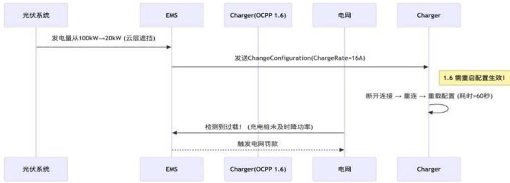
由于 OCPP 1.6 的配置是设备级参数修改，需充电桩重启配置才能生效，无法实现 <300ms 的实时响应。
